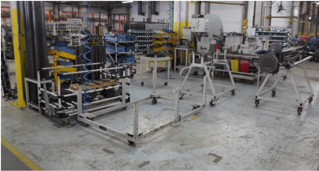
Figura 3 – Falta de definição de local para dispositivos e peças
