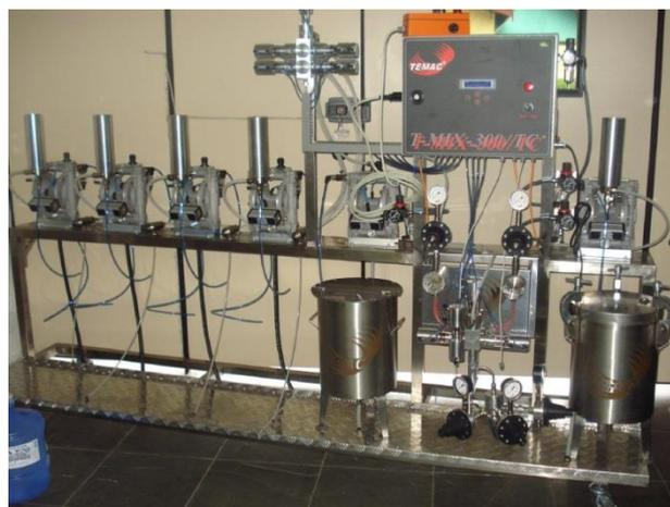
Figura 8 - Máquina dosadora de tinta
