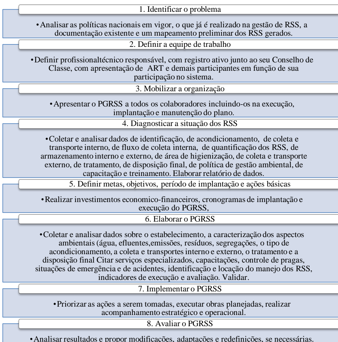
Figura 1 Etapas para elaborar e programar um PGRSS. Adaptação do Manual de gerenciamento de resíduos de serviços de saúde (2006). Fonte: Autores.
