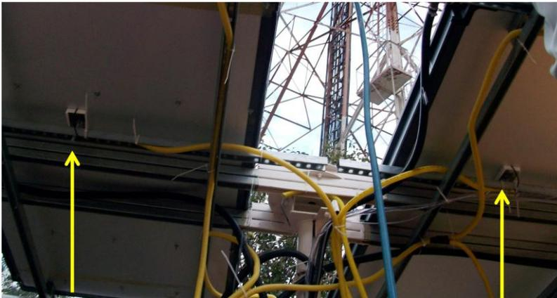
Figura 3 – Posição dos termômetros na parte posterior do painel solar
