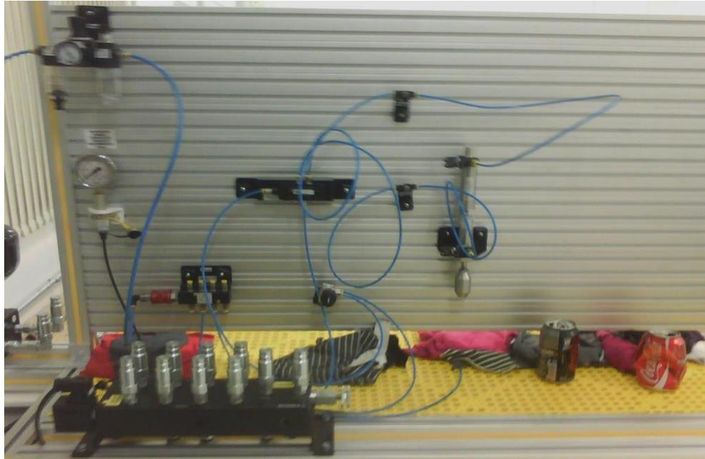
FIGURA 2 - Teste do sistema pneumático na bancada de ensaios da Parker. Fonte: Elaborada pelos autores
