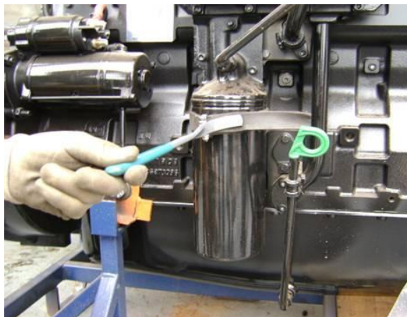
Figura 4 – Ferramenta de verificação de aperto
