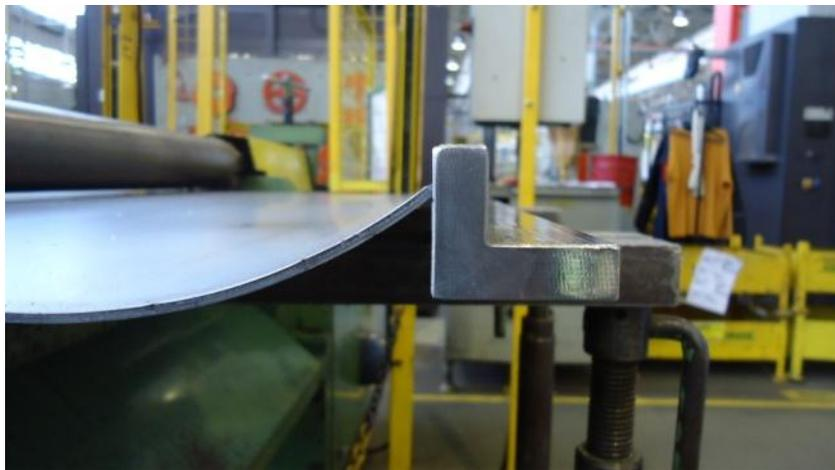
Figura 4: Peça alinhada ao dispositivo. Fonte: Empresa pesquisada.
