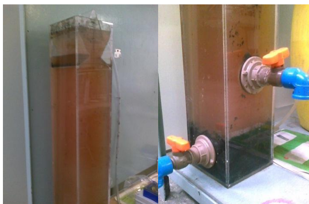
Figura 3 - Reator UASB em escala laboratorial. Em detalhes o separador de fases (esquerda) e o lodo inicia (direita).
